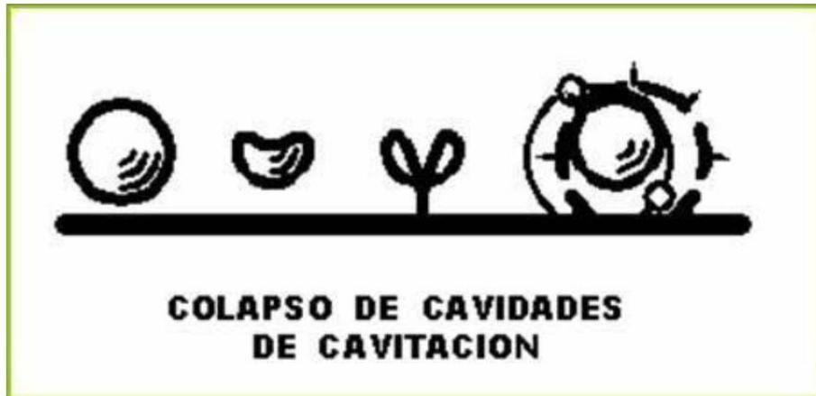
Figura 2.13.- Esquema colapso de burbuja por cavitación
