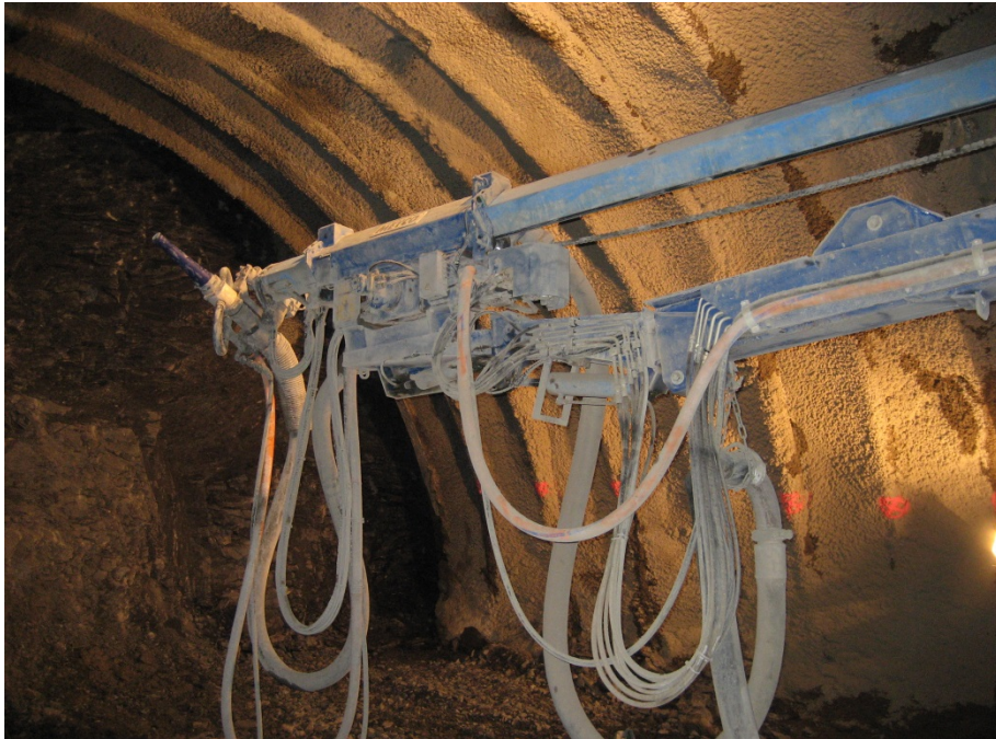
Foto 2.5 – Vista lanzas robot gunitado
